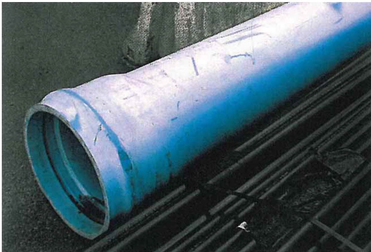
FIGURE A1 CE TUYAU SOUS PRESSION DE GRAND DIAMÈTRE A ÉTÉ ENTREPOSÉ À L'EXTÉRIEUR ET SANS PROTECTION PENDANT 15 ANS
